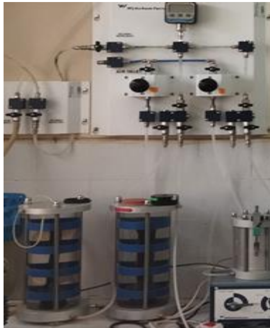
Figure 3. 6: Système de pression avec les cellules Air-eau
