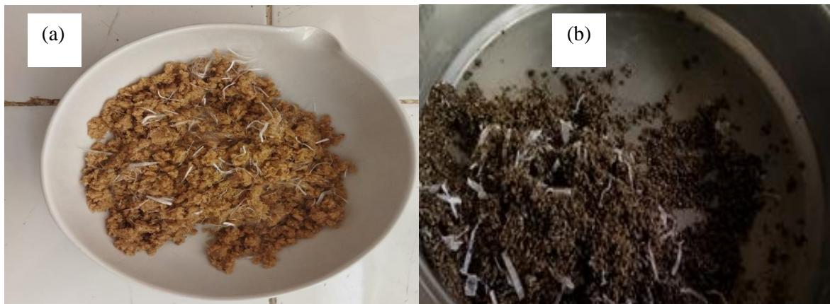
Figure 3. 3: Mélange de sable et de fibres : (a) fibre de polypropylène ; (b) fibre de plastique recyclée
