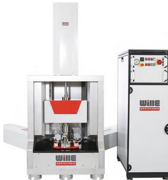
Figure 3. 11: Dispositif de cisaillement simple cyclique utilisé dans cette étude
