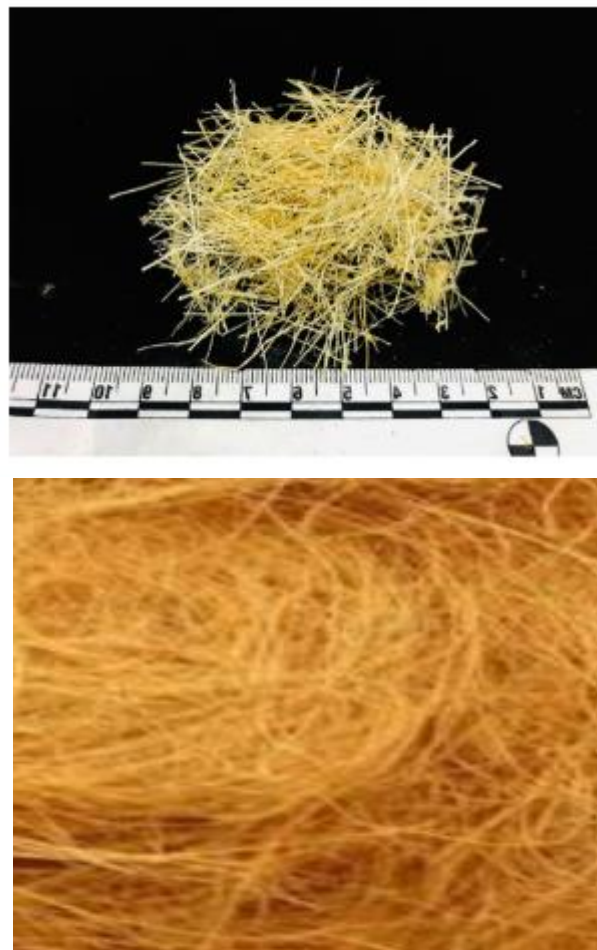
Figure 2. 5: Les fibres végétales (a) Fibre de sisal (Hao et al., 2023), (b) Fibre de Coir (Kaushik & Singh, 2021)
