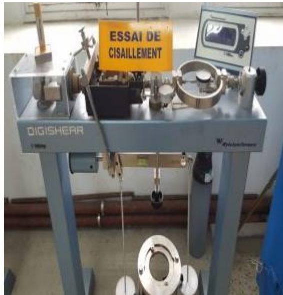
Figure 3. 1: Boîte de cisaillement direct du laboratoire de mécanique de sol (ENSH BLIDA)
