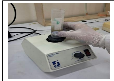
Figure 19 : Homogénéisation du prélèvement
