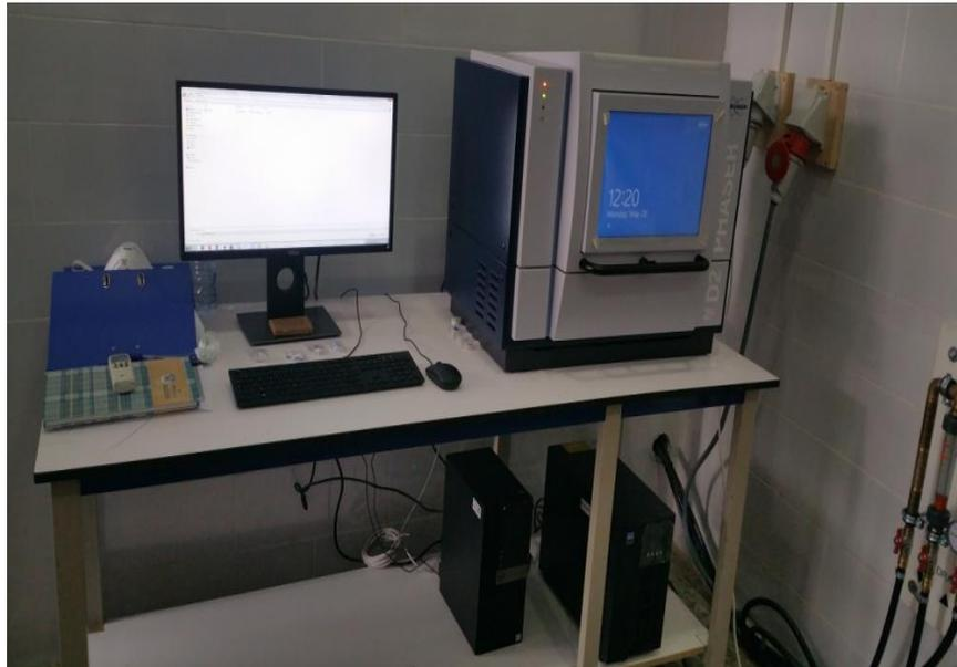
Figure(III.12) : Photographie de l'appareil utilisé pour réaliser DRX.
