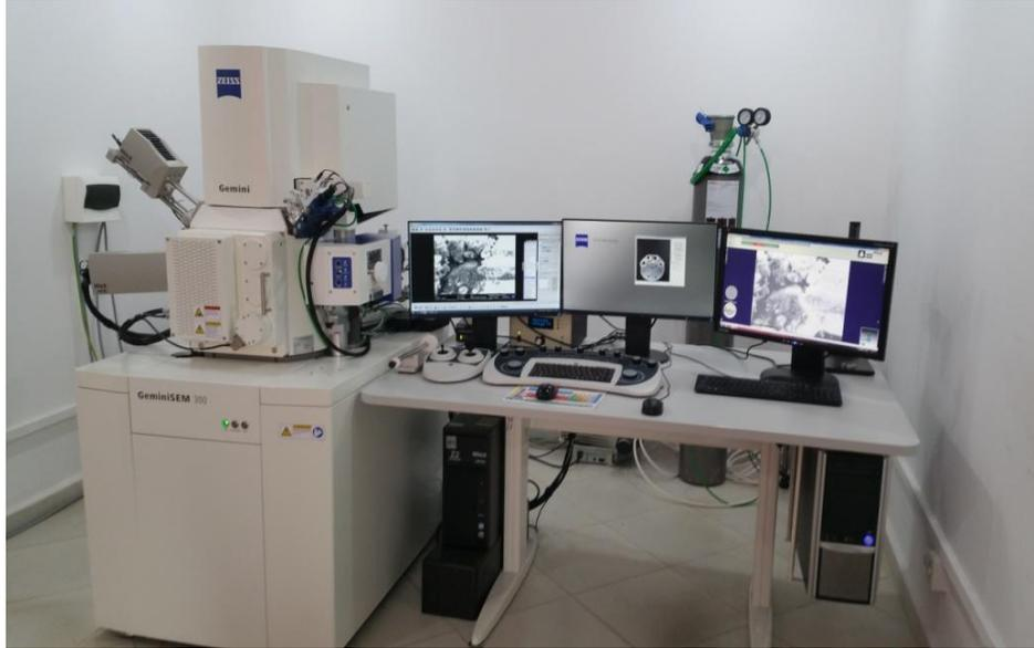
Figure (III.9) : Photographie de l'appareil MEB équipé d'un détecteur EDS.
