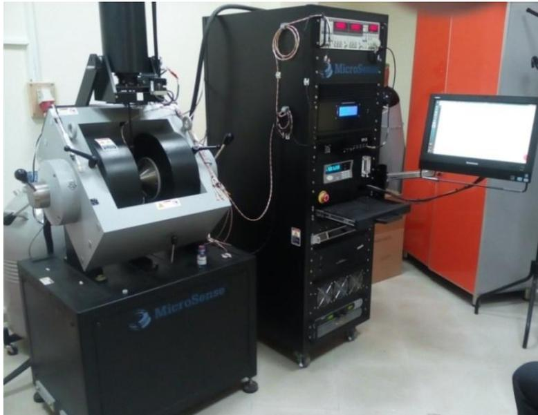
Figure (III.14): Magnétomètre à échantillon vibrant(VSM) du CRTI.
