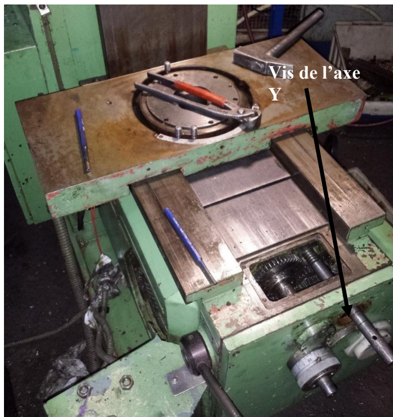
Figure 5.44 Démontage de la vis de l'axe Y.
