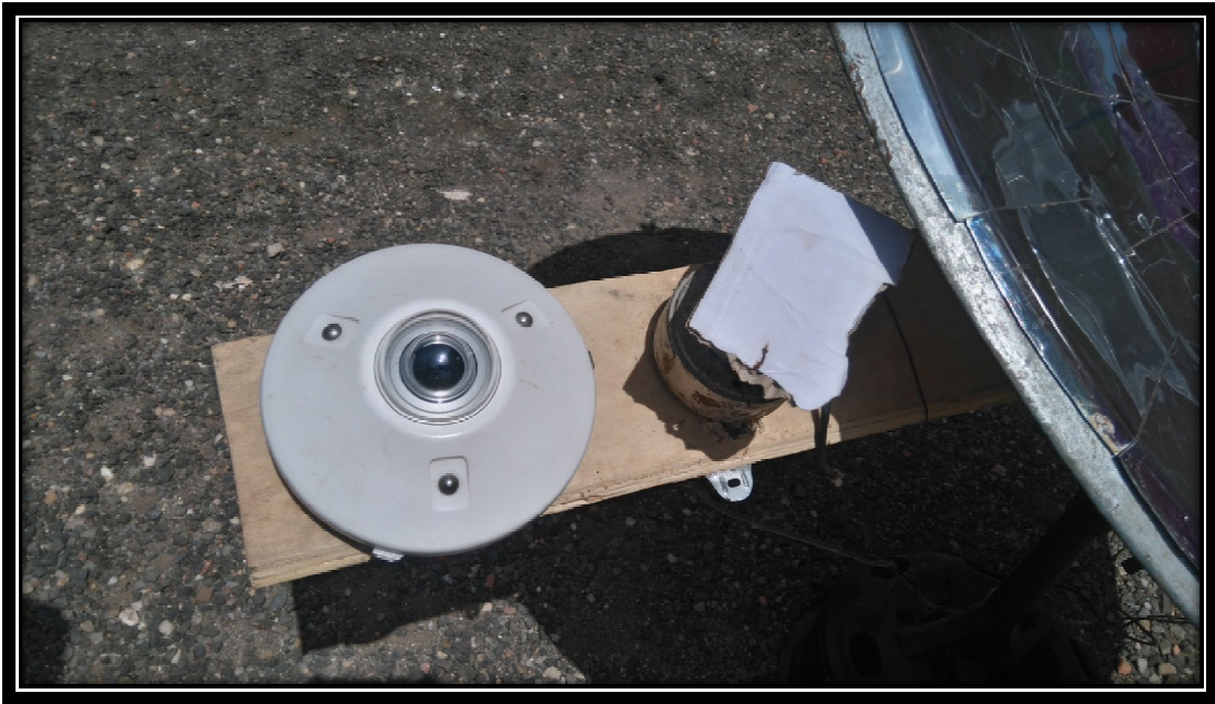
Fig IV. 10 : Les deux pyranomètres sont fixé sur un support attaché à l'axe de la parabole.
