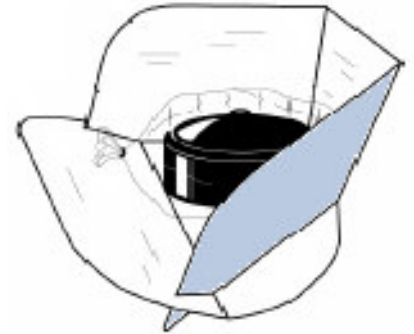
Fig I. 2 : Schéma de principe d'un cuiseur à panneaux [17].
