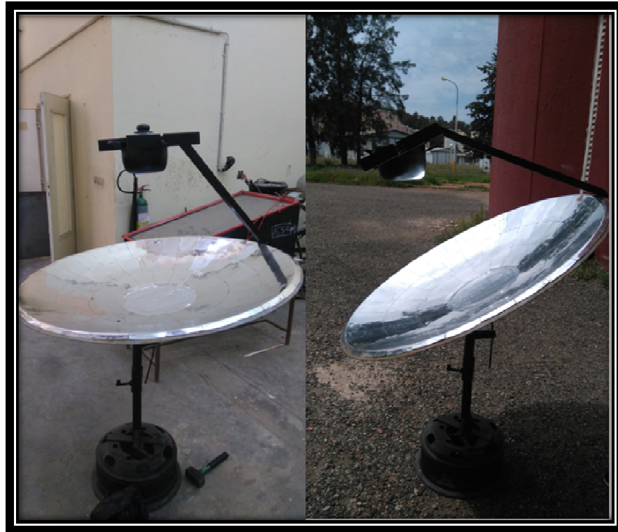
Fig IV. 6 : Vue générale du prototype du cuisinier solaire
