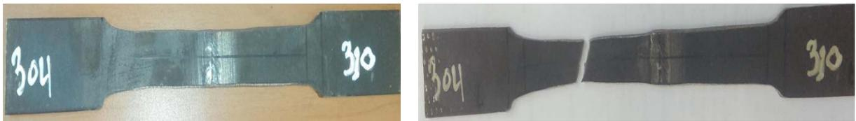
Figure IV.44. Eprouvettes de traction soudée 304L-310L avant essai et après rupture.
