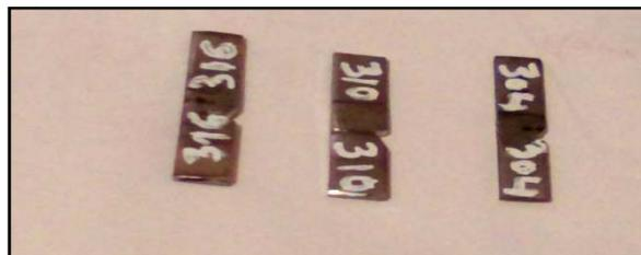
Figure III.18. Les éprouvettes de résilience (316L-316L /310L-310L / 304L-304L) entaillée.
