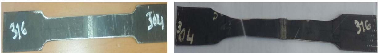
Figure IV.42. Eprouvettes de traction soudée 304L-316L avant essai et après rupture.
