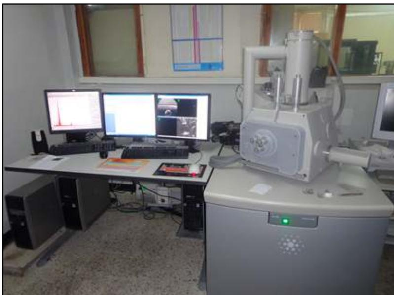
Figure III.11. Microscope Electronique à balayage QUANTA 600-FEI
