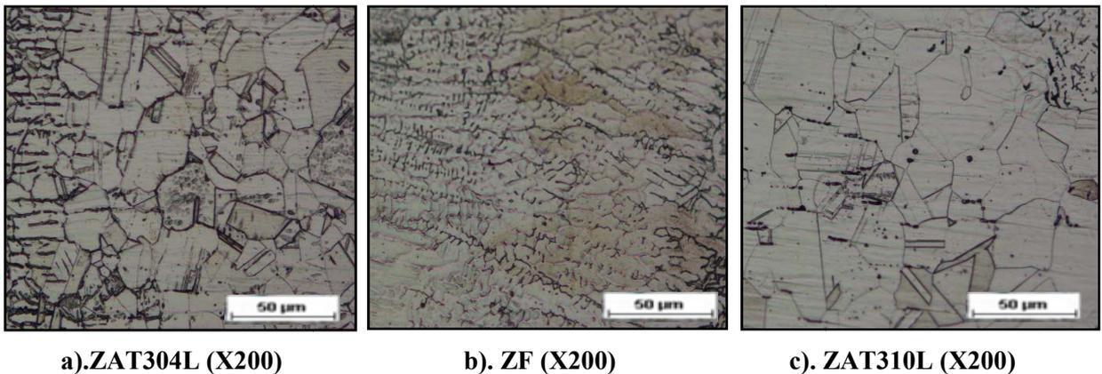
Figure IV.9. Microstructures du cordon de soudure 304L-310L
