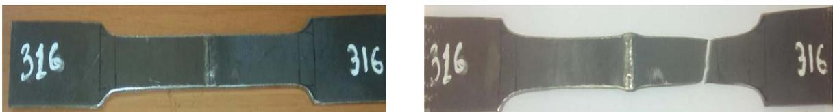
**Figure IV.40 Eprouvettes de traction soudée 316L-316L avant essai et après rupture.**
