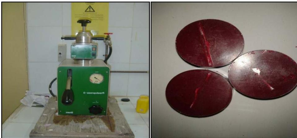
Figure III.9. Machine enrobeuse et les échantillons enrobés par la résine.
