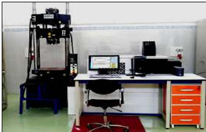
**Figure III.13. Machine de traction**
