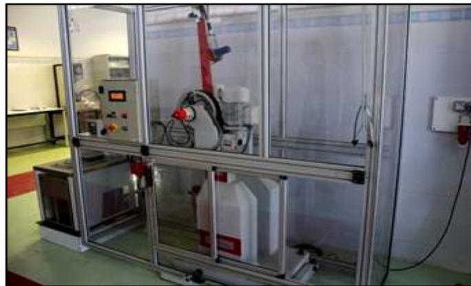
Figure III.17. Mouton pendule ou mouton de Charpy.
