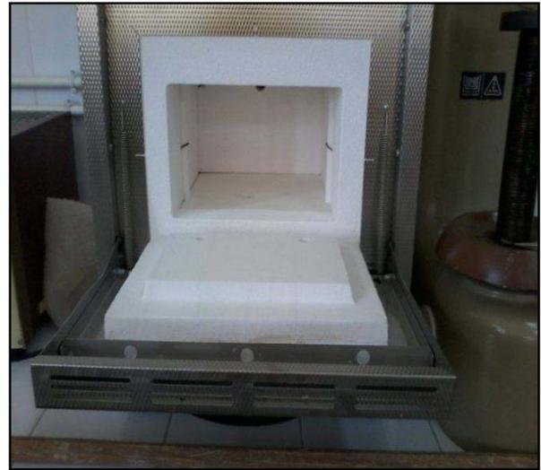
Figure III.6. Image du four utilisé pur les traitements thermiques
