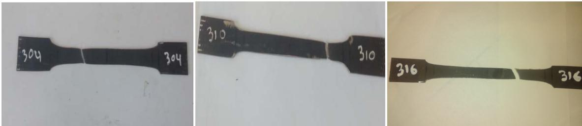
Figure IV.34. Eprouvettes de traction des métaux de base après la rupture.
