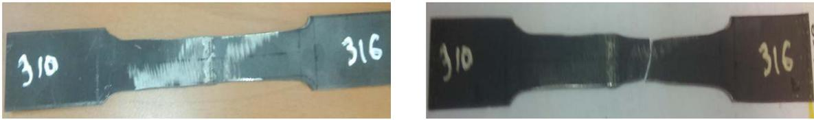
Figure IV.46. Eprouvettes de traction soudée 310L-316L avant essai et après rupture.
