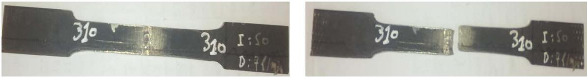
**Figure IV.38. Eprouvettes de traction soudée 310L-310L avant essai et après rupture.**
