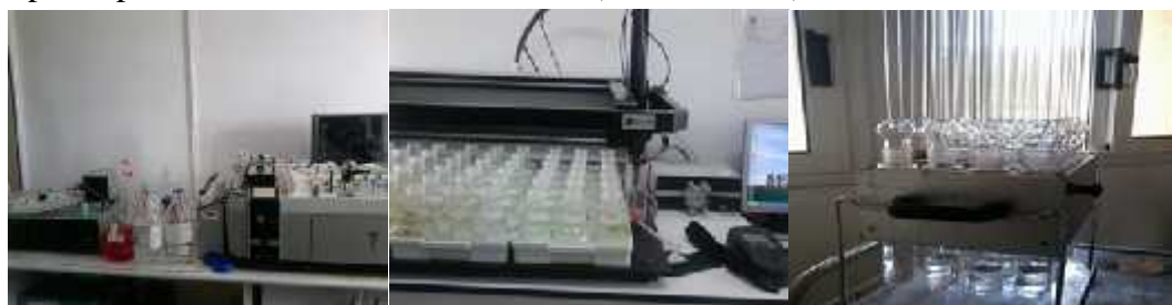
L'auto analyseur à flux continu SKALAR SAN++ SYSTEM
