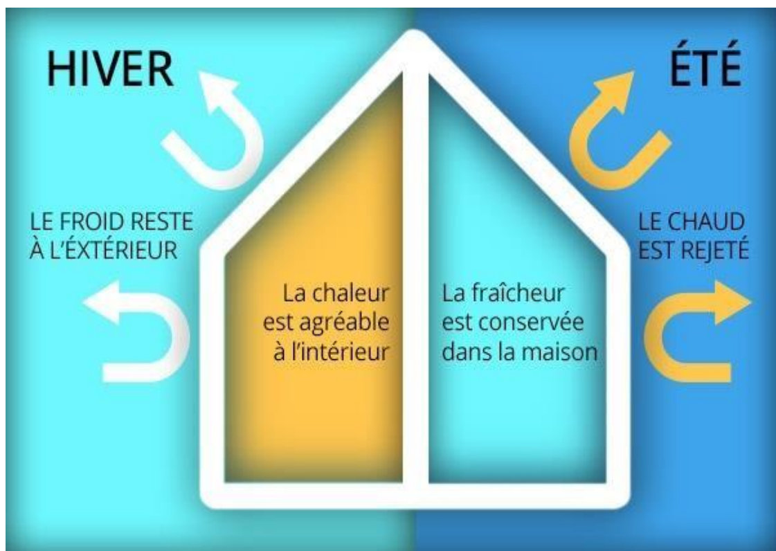
Figure 1. 10 : L'inertie dans une maison passive [27]
