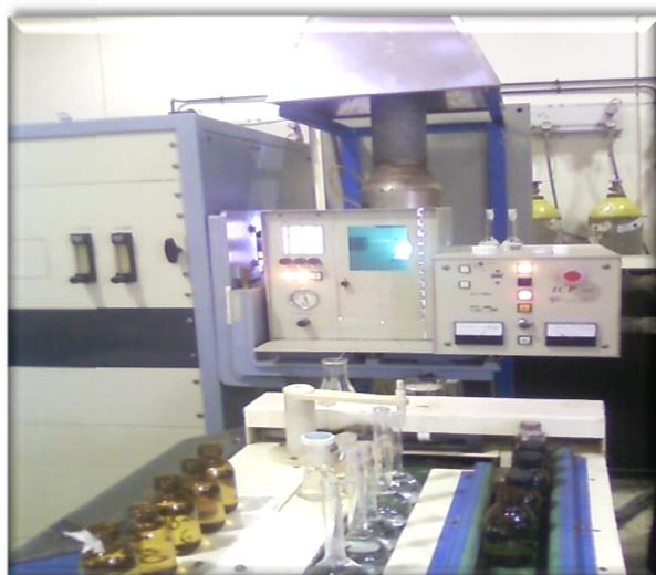
**Figure 07 :** spectromètre d'émission à plasma JY 32(ICP).
