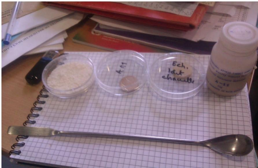
**Figure 12:** conditionnement des échantillons sous forme de pastilles dans de boites de pétri (photographie personnelle).
