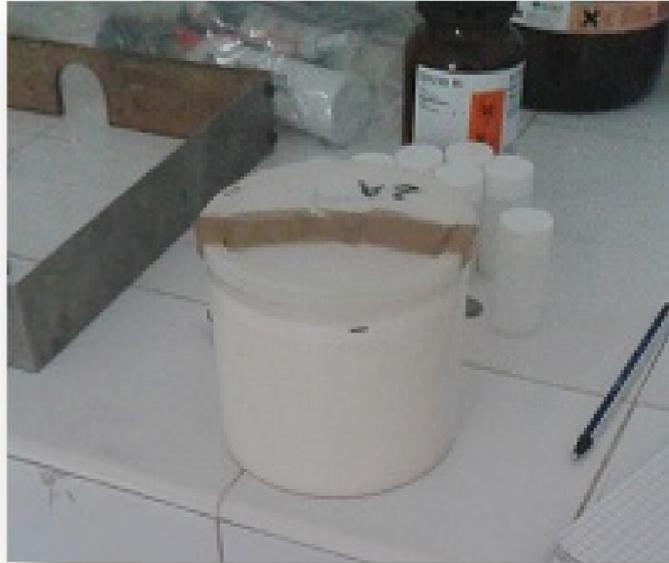
**Figure 11** : 500ml du lait de chamelle dans un porte échantillon Marinelli.
