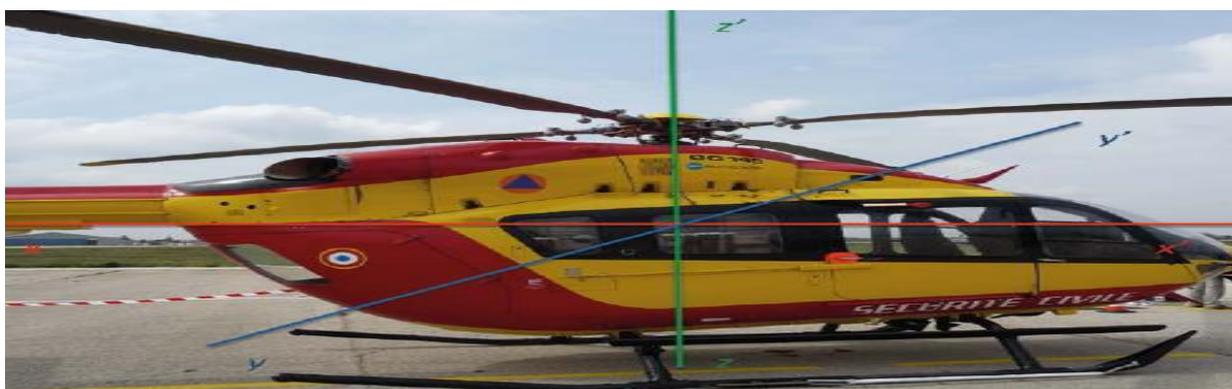
**Figure II.10 :** Rappel des trois axes ( $x-x'$  : axe de roulis -  $y-y'$  : axe de tangage -  $z-z'$  : axe de lacet)
