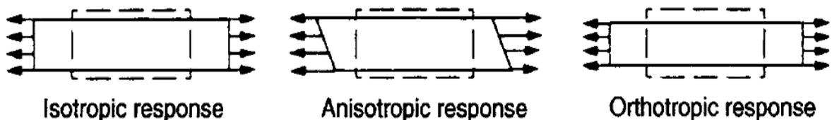
**Figure I.3 :** Réponse de matériau isotrope, anisotrope et orthotrope à un chargement axial.
