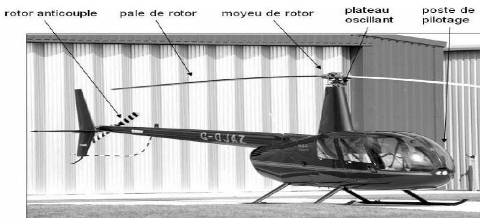
**Figure II.1 :** Hélicoptère avec un rotor principal à deux pales.
