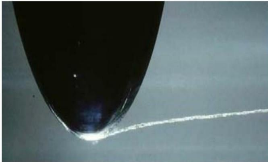
Figure 2-6 : Cavitation par filaments tourbillonnaires
