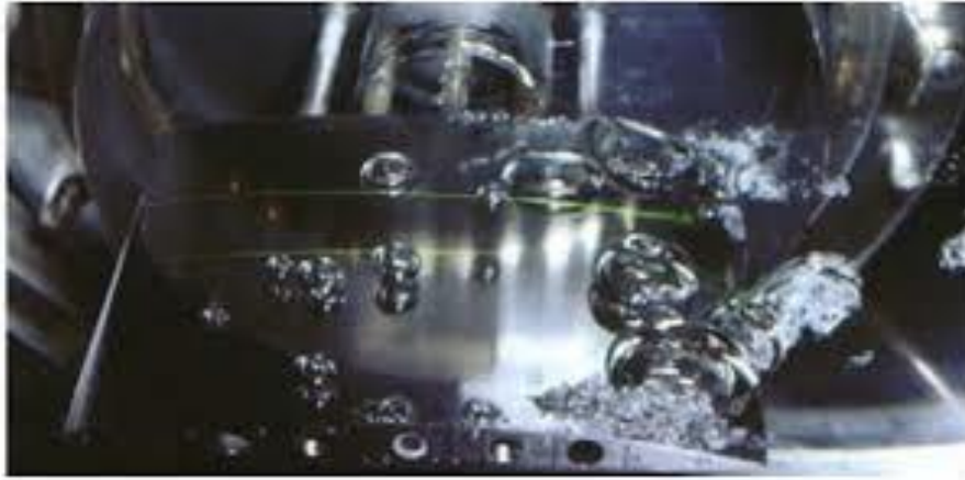
Figure 2-4 : Développement de la cavitation à bulles sur l'extrados du profil 2D.
