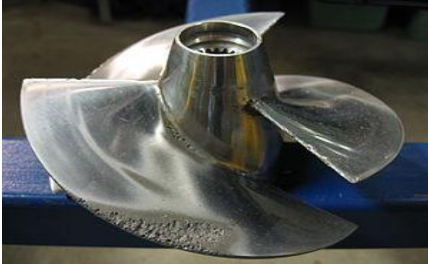
Figure 2-8 : Apparition de bulles de cavitation sur les pales d'une hélice
