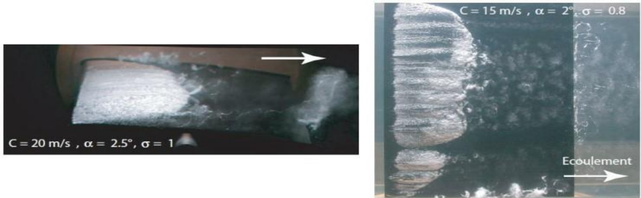
Figure 2-3 : Développement de la cavitation à Poche attachée sur l'extrados du profil 2D
