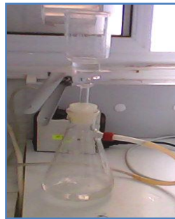
Rampe de filtration
