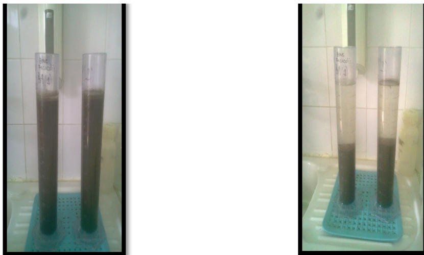
Figure n°33. L'eau brute avant et après 30 min de décantation (photos originales).
