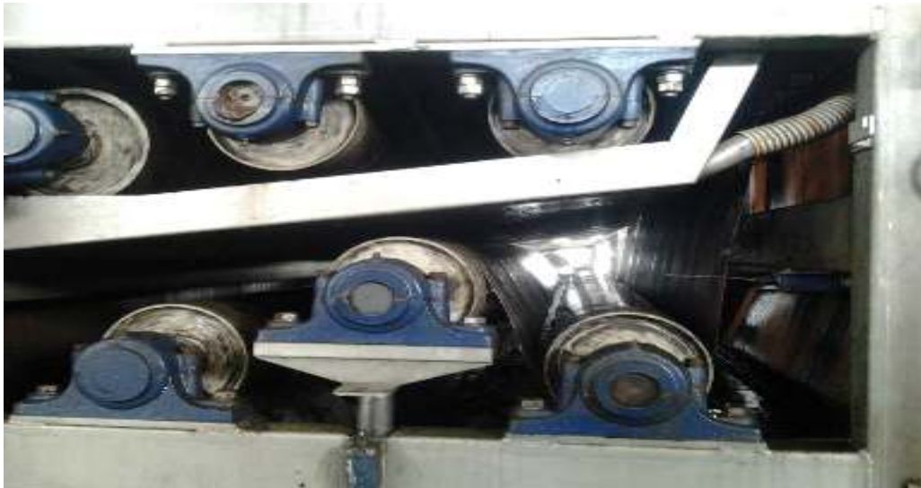
Figure n°13. Filtre à bande.
