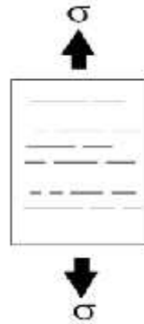
Figure II.5 : Matériau endommagé et sain ayant la même déformation.
