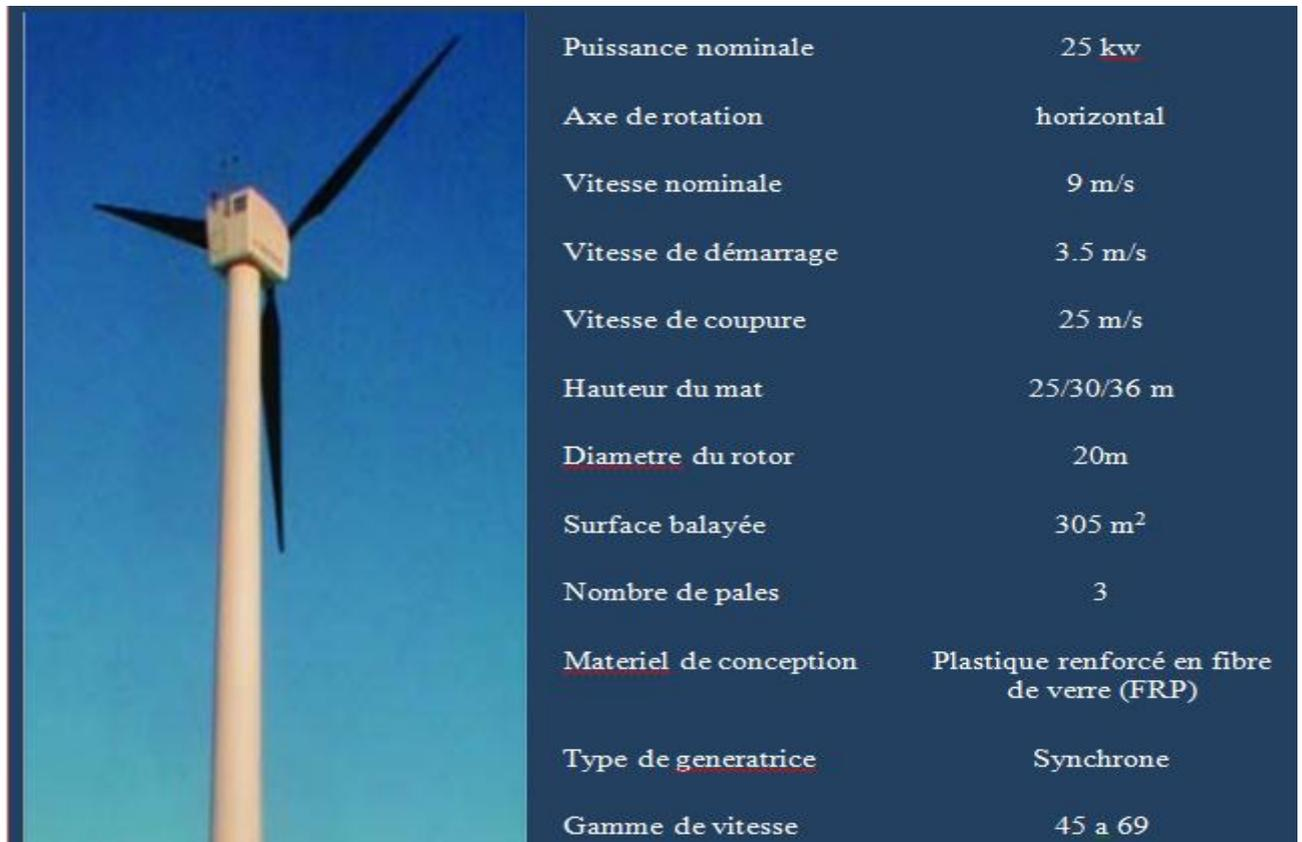
Figure 4.8: Caractéristiques de l'aérogénérateur PGE 20/25
