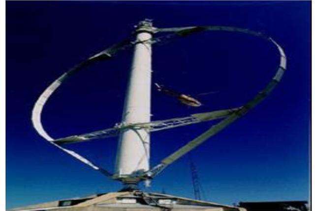
Figure 3.7: Éolienne de type Darrieus
