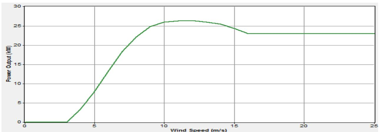
Figure 4.9: Courbe de puissance de l'aérogénérateur PGE 20 /25
