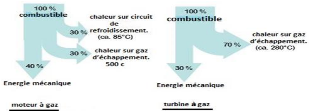
Figure1.9 : Rendement et température de fonctionnement d'un moteur et d'une Turbine [10]
