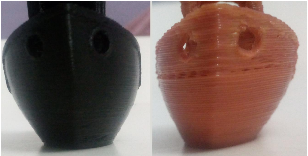
Figure 4.19: Avant (droite) et après (gauche) l'algorithme d'accumulation d'erreurs
