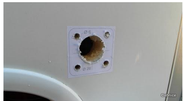
Fig.2.8 : Gabarit adhésif facilitant grandement le perçage 28mm
