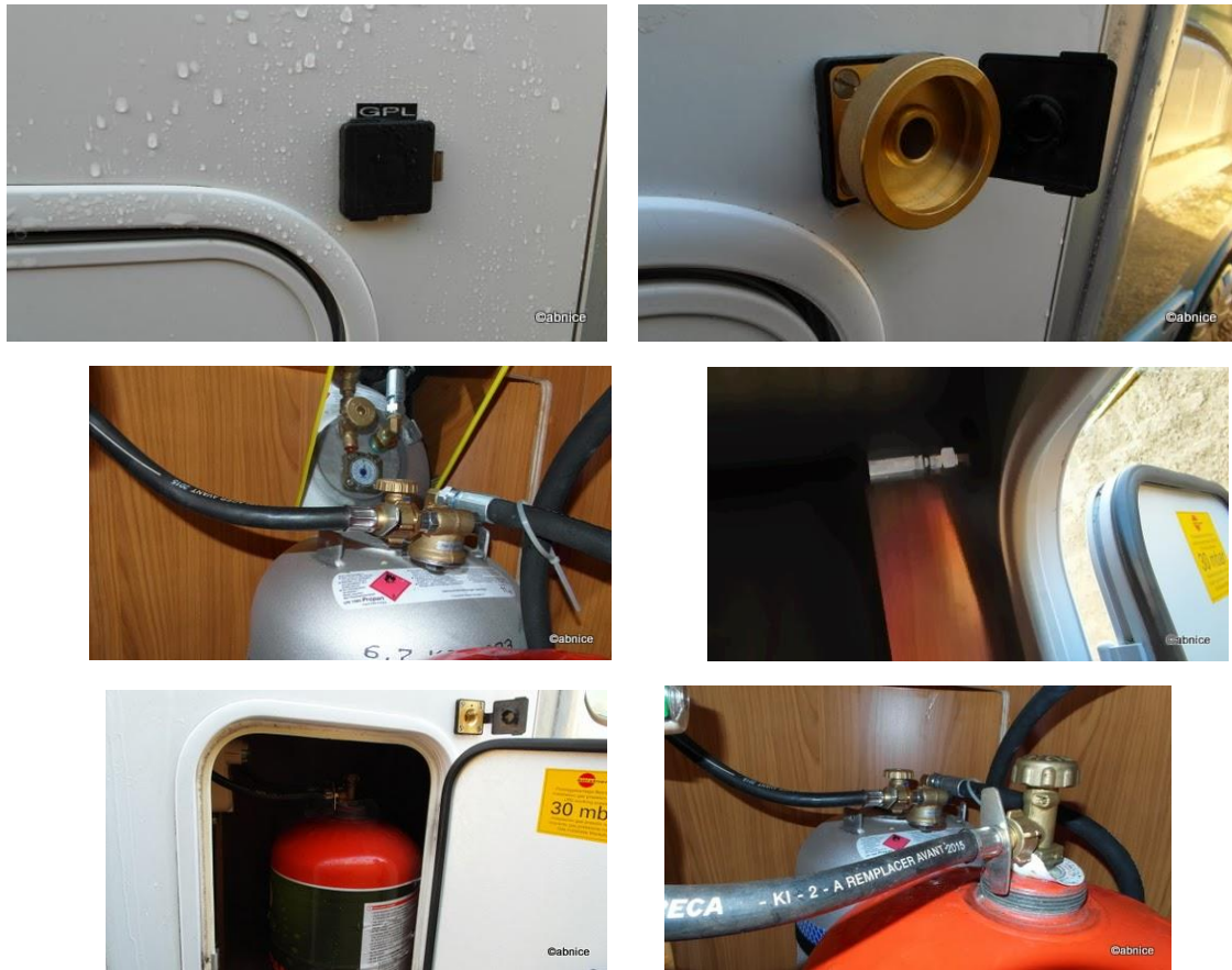
Fig.2.9: Mise en place de la coupelle de remplissage sur la carrosserie 4 vis Inox 5x50mm + Adaptateur
