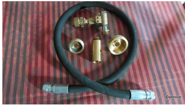
Fig.2.6 : Kit de remplissage externe simple pour remplissage de bouteille GPL à l'extérieur du véhicule.
