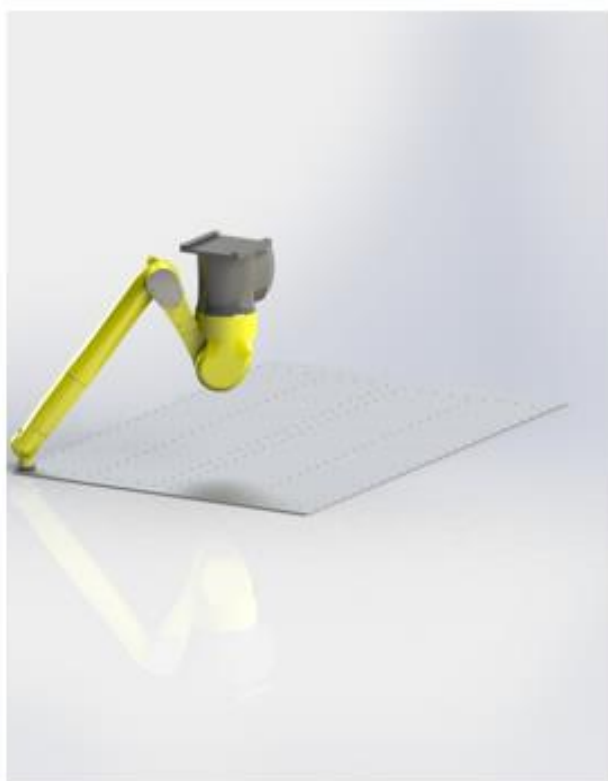
Figure 4. 2: Bras manipulateur à quatre axes suspendu
