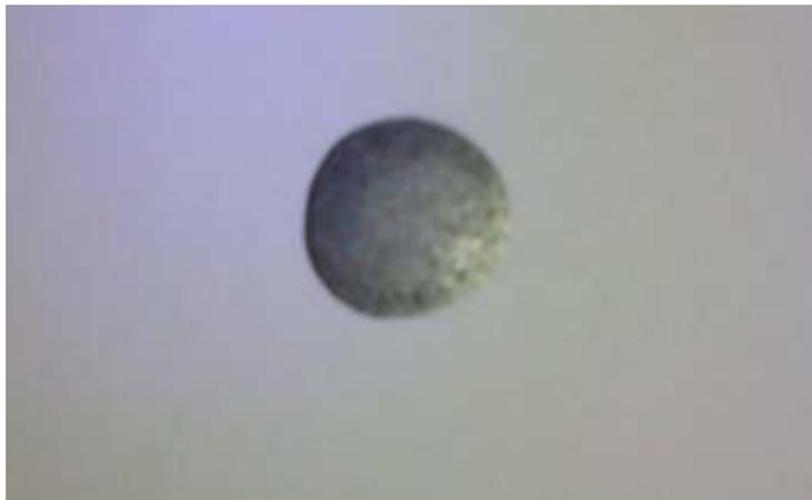
Figure III.1 : échantillon Phase Max  $Ti_2AlC$  élaboré.
