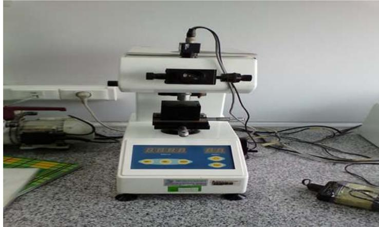
Figure III.10: Microduromètre.
