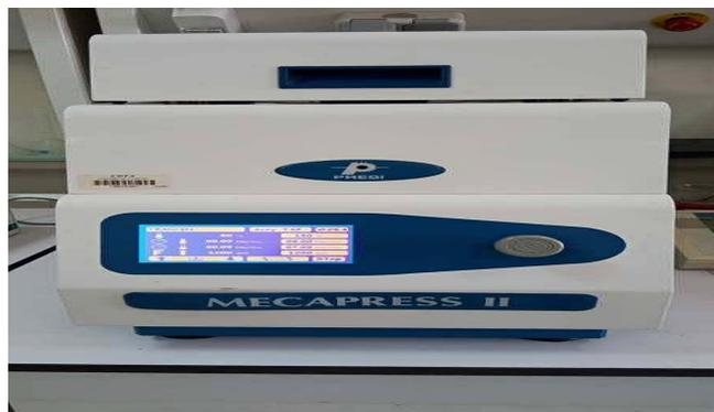
Figure : III.5: Enrobeuse automatique MECAPRESS II.
