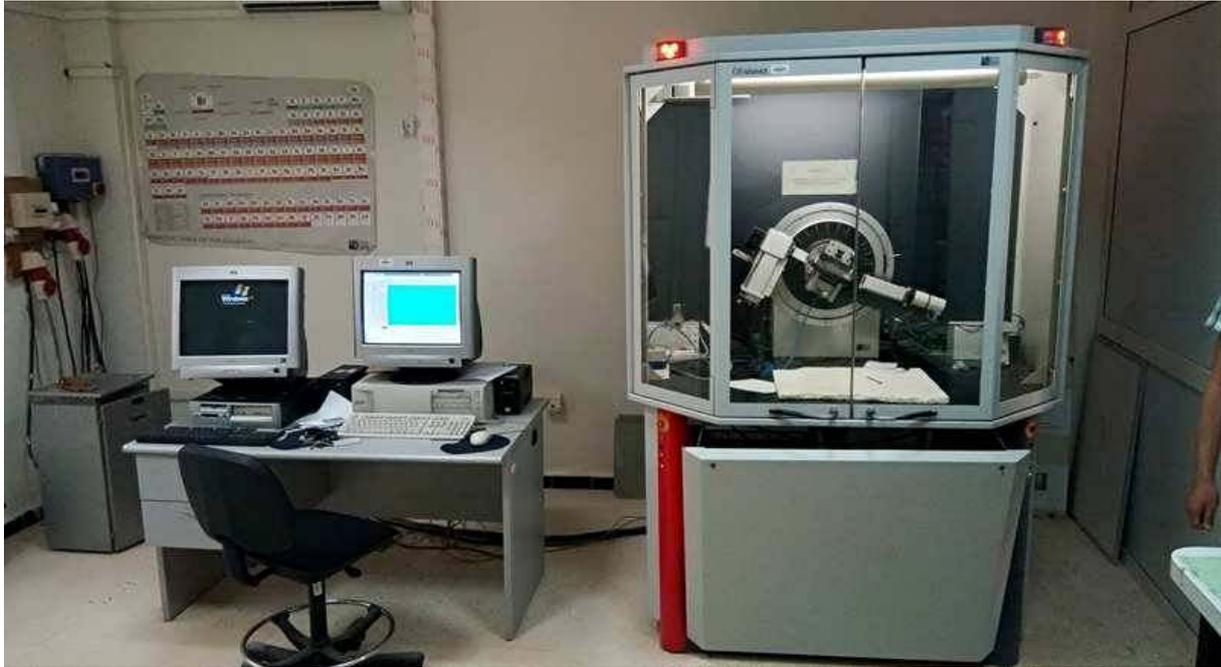
Figure III.11 : Diffractomètre à rayons X de type Bruker D8 ADVANCE.
