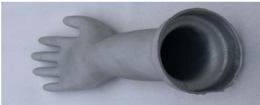
Figure I. 9 : Gant réalisé par coulée en barbotine et frittage. Outre ses bonnes propriétés thermiques et mécaniques, cette phase assure un bon mouillage puis démouillage du polymère, et résiste parfaitement aux acides utilisés (d'après le site de [www.3one2.com](http://www.3one2.com))
