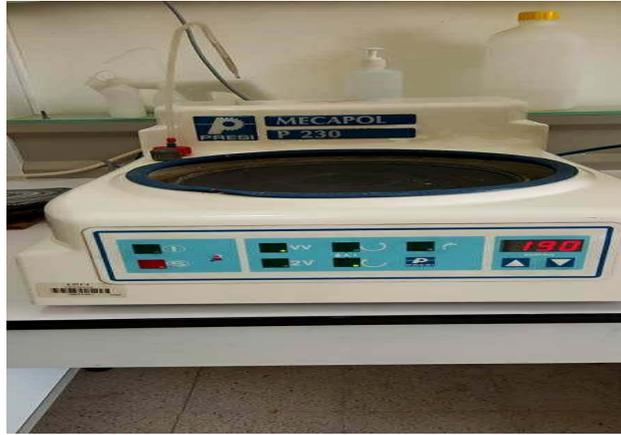
Figure : III.6: Polisseuse automatique Mecapol 230.
