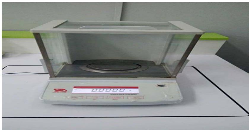
Figure III.13: balance de précision.
