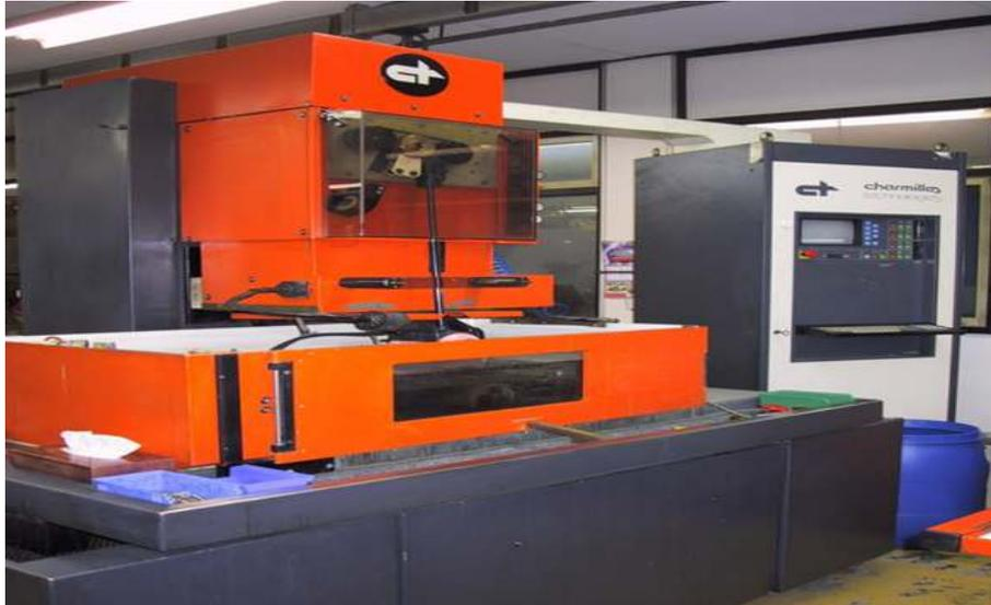
Figure III.4 : Machine de découpe par électroérosion ROBOFIL 200.
