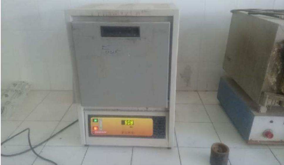
Figure III .2 : four électrique à moufle.
