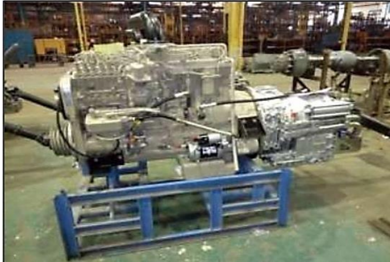
Figure I-6 Moteur et boîte de vitesse implantés sur l'autobus 100L6
