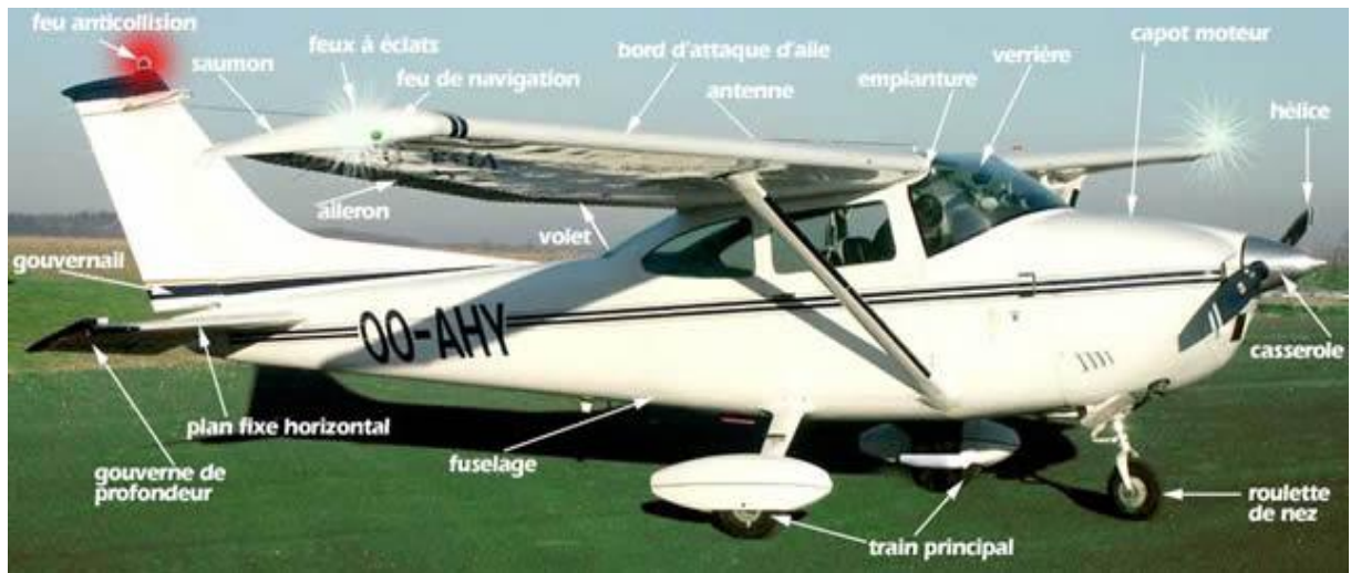
Fig. I.8 Les principaux organes de l'avion
