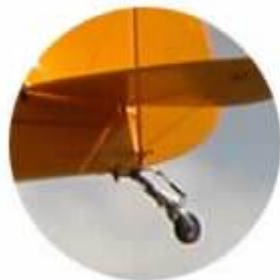
Fig. I.17.a le train classique ou conventionnel
