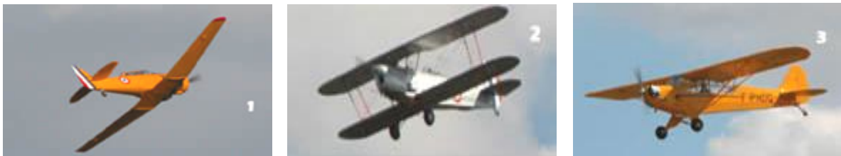
Fig. I.10 Les types de l'aile
