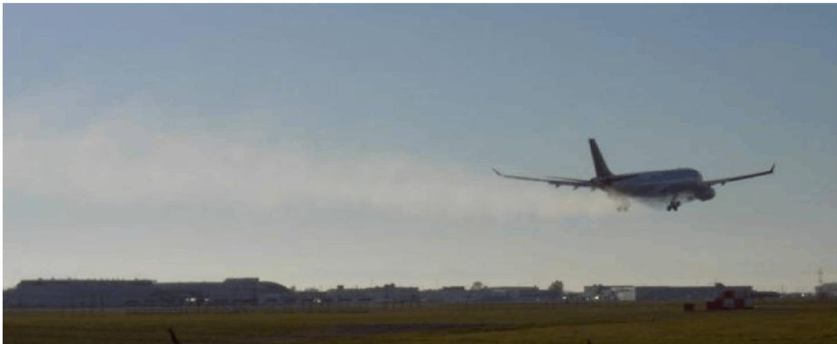
**Figure IV-5 :** Fuite de carburant visible en provenance du vol ACA216
