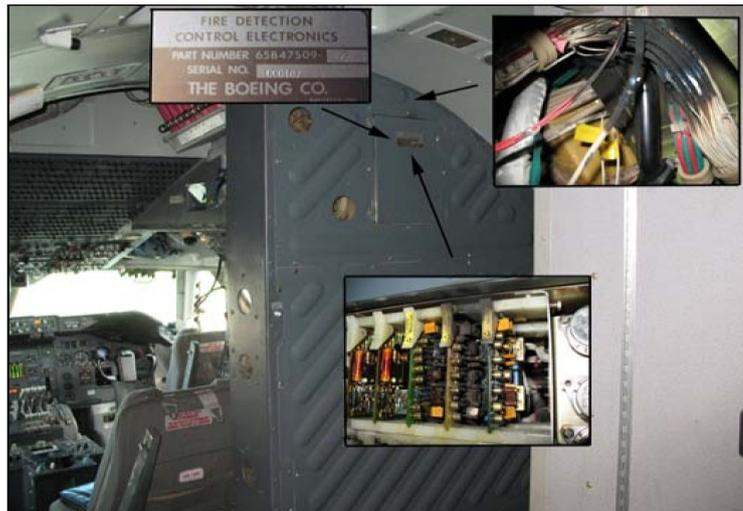
**Figure IV-1** : Dommages causés par l'incendie au panneau P6
