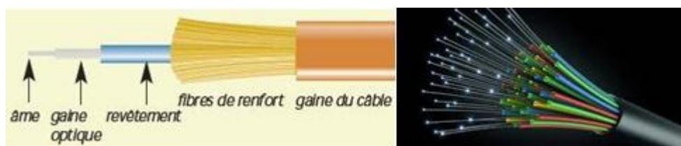
Figure 1.2. La fibre optique [29] [30].
