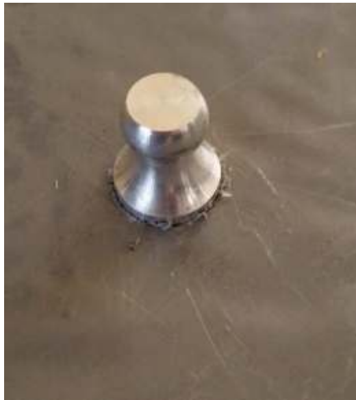
Figure 3-3 : Plot collé sur la surface du polyuréthane avant l'essai d'adhérence
