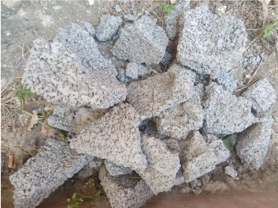
Figure 3-9: Parpaing non revêtu après essai au choc.
