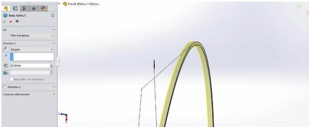
Figure 75 : bossage extrude du cordon de soudure du fond bombé
