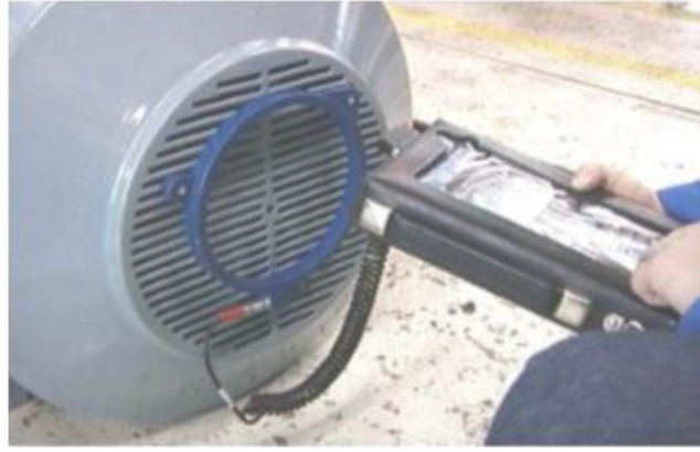
Figure.3.3 : Mesure du flux axial [18].
