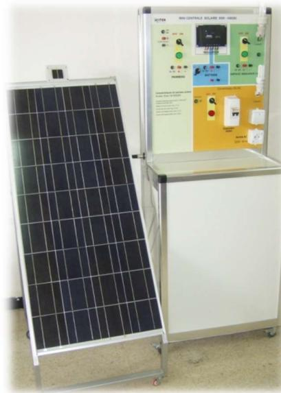
**Figure (III.2) :** Banc didactique d'étude d'énergie solaire photovoltaïque HSE80<sup>(1)</sup>
