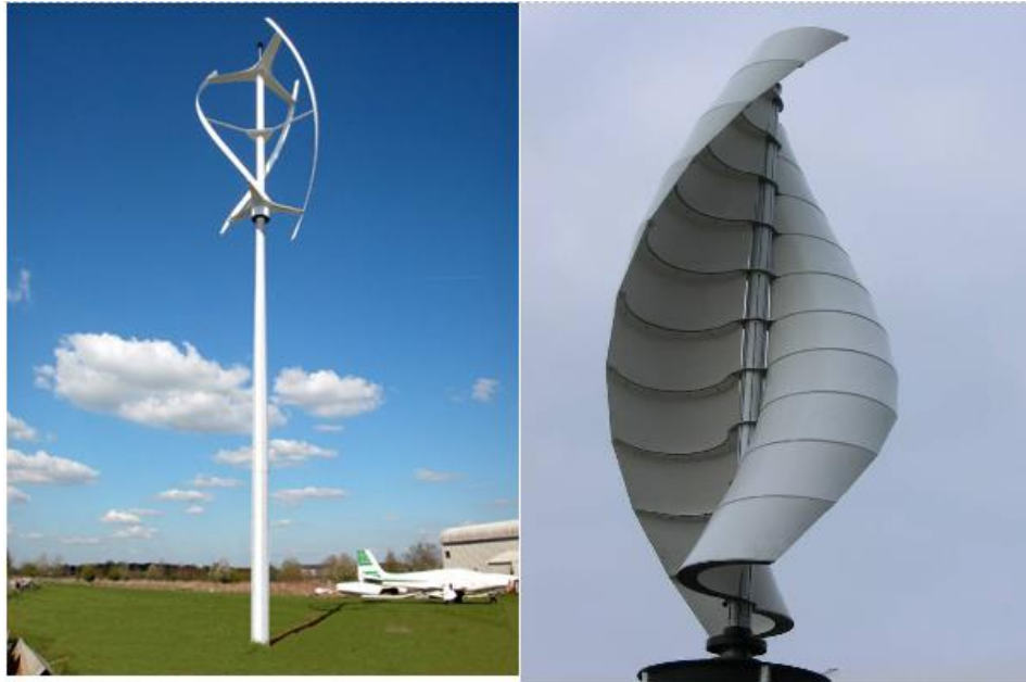
Figure 12 Exemple d'éolienne Darrieus (à gauche) et Savonius (à droite).
