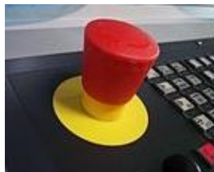
Figure II.12: bouton d'arrêt d'urgence sur tableau de commande.
