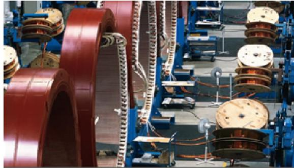
Figure (I.13). Chaîne de fabrication de générateurs d'éoliennes.
