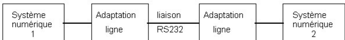
**Figure III-14 : schéma fonctionnel d'une liaison série asynchrone de la norme RS232.**
