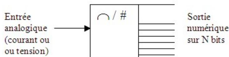
**Figure II-4 : Principe de conversion analogique / numérique [5].**
