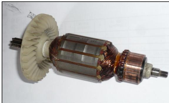
**Figure 1.3 :** Rotor bobiné
