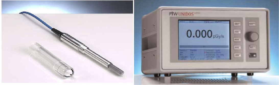
Figure 3.16: Chambre Farmer et électromètre UNIDOS webline de PTW [31].
