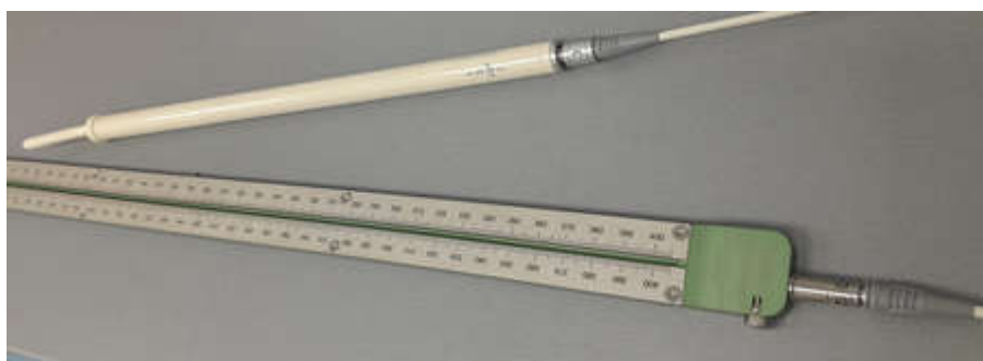
Figure 3.22 : Mesure de la position la plus distale de l'applicateur avec le simulateur de position.
