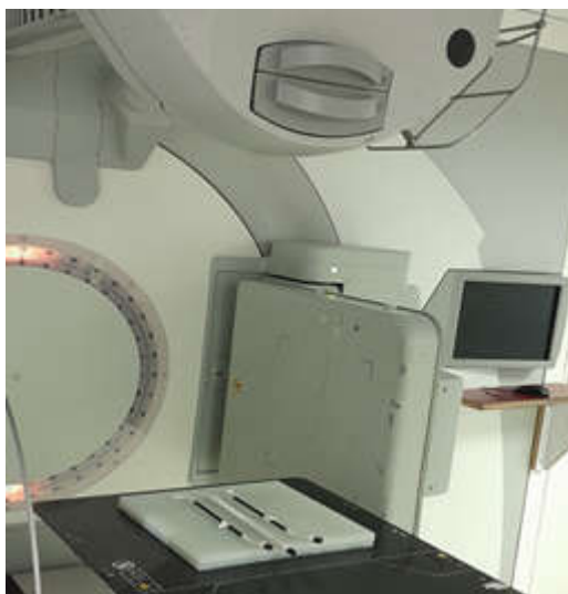
Figure 3.21 : Irradiation de l'ensemble applicateur-marqueur avec le système XVI.
