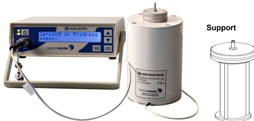
Figure 3.12 : Chambre d'ionisation puit HDR1000 Plus et l'électromètre MAX 4000 de Standard Imaging [29].
