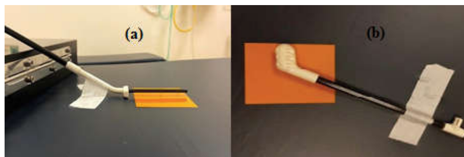
Figure 3.19 : Mise en place des tubes de l'applicateur Geneva pour les mesures avec le film (a) tube intra-utérine, (b) le tube ovoïde.
