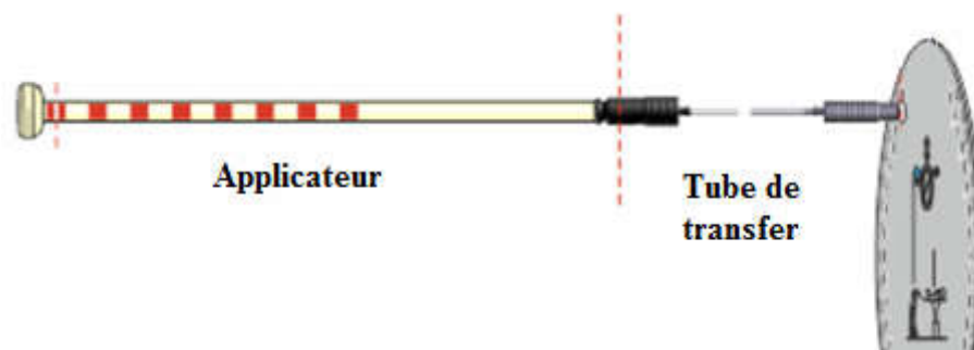
Figure 2.5 : Connection du projecteur et l'applicateur avec un tube de transfert [22].
