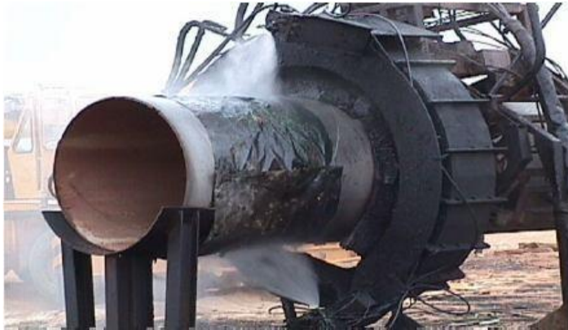
Figure 2.11 : Revêtement d'un tube par le polyéthylène [15]
