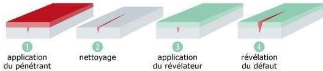
Figure 2.23 : contrôle par ressuage
