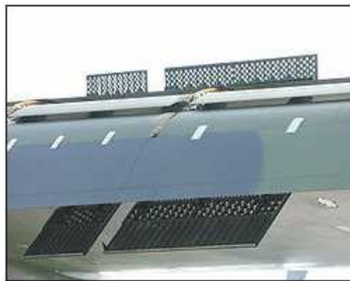
Fig. I-2 : Spoilers et aérofreins
