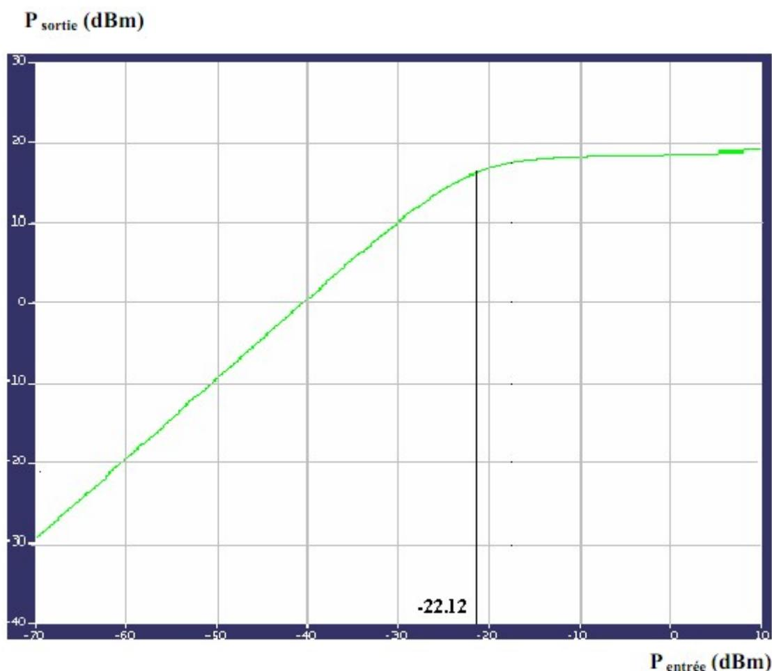
**Figure III.2 : Puissance de sortie en fonction de la puissance d'entrée.**
