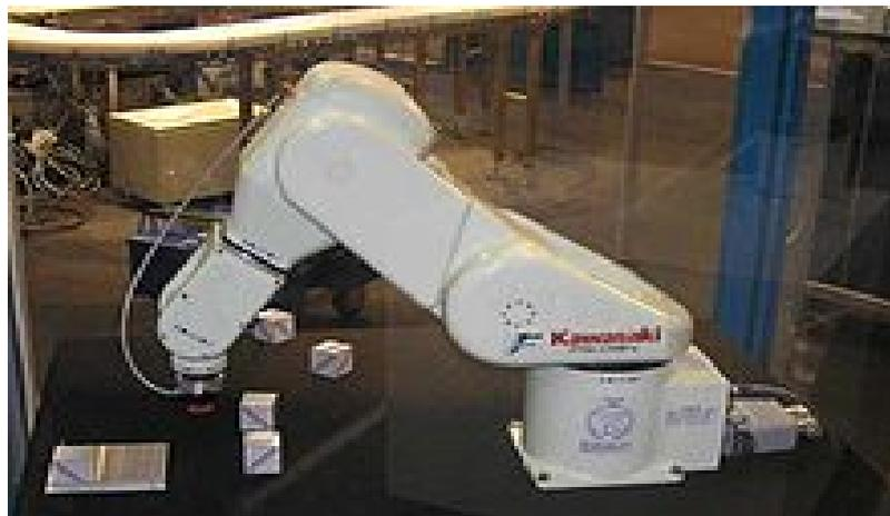
**Figure I.3 :** Le robot industriel Kawasaki FS-03N, robot de soudage. [3]
