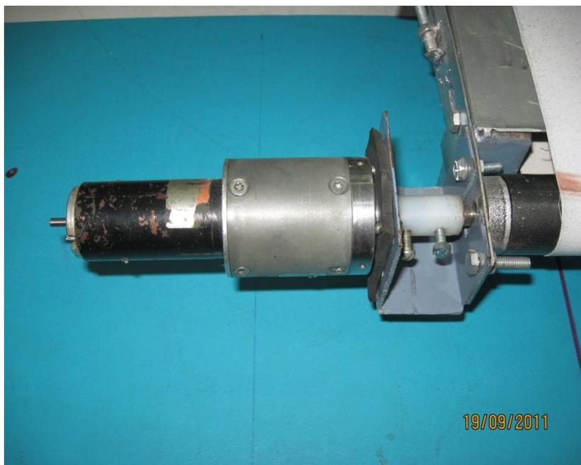
**Figure III.10** : Moteur qui fait la rotation du convoyeur.
