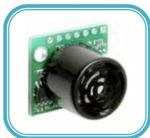
Fig.5.4 Télémètres ultrason LVEZ4
