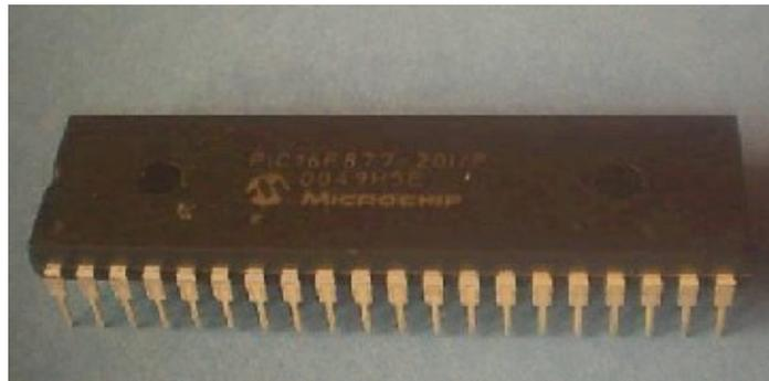
**Figure 1.2** : photos réelle d'un PIC16F877
