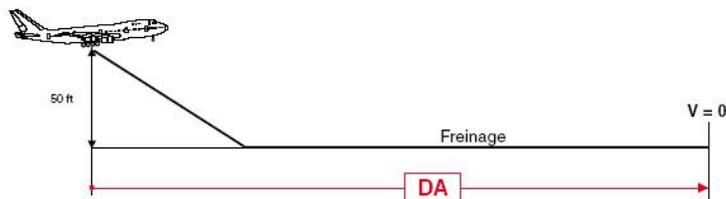
Figure (I-18) La distance d'atterrissage
