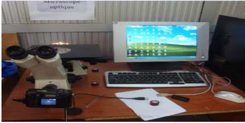
Figure 3.13 : Microscope optique utilisé pour l'analyse métallographique
