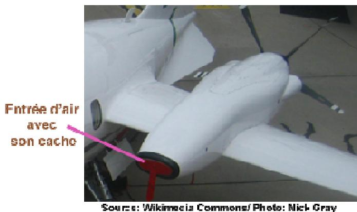
Figure II.4. Schéma de l'entrée d'air axiale
