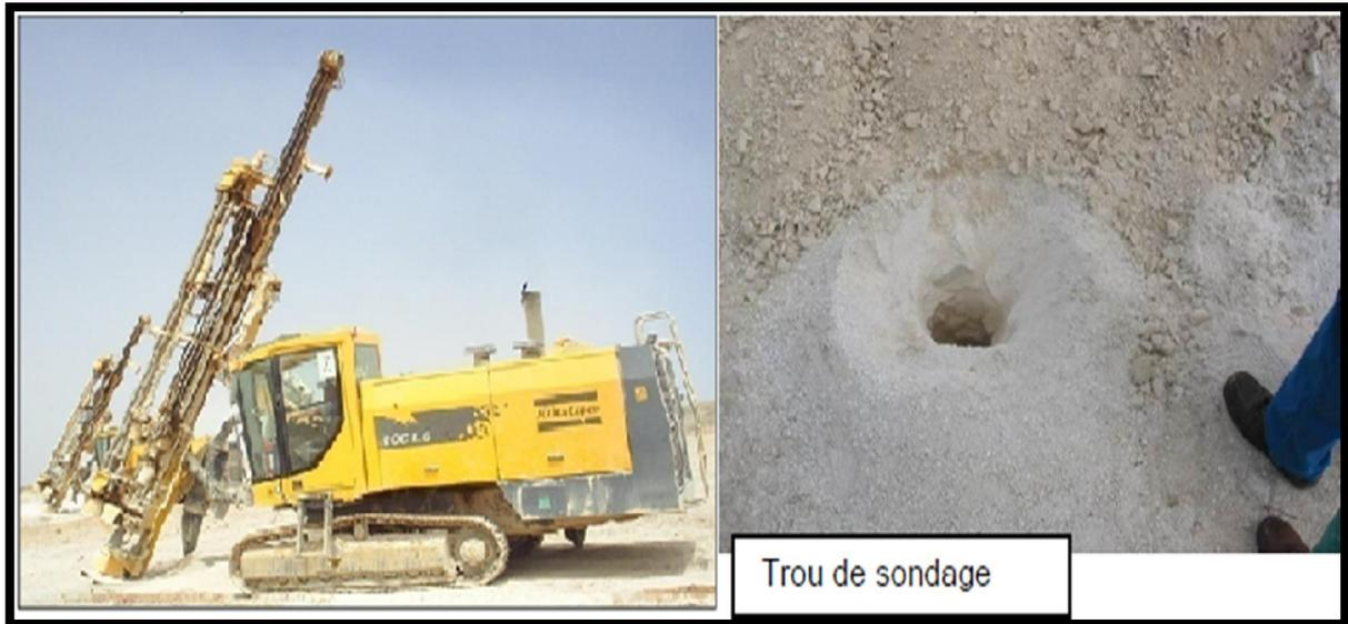
**Figure 1.4** Abattage par sondeuse.
