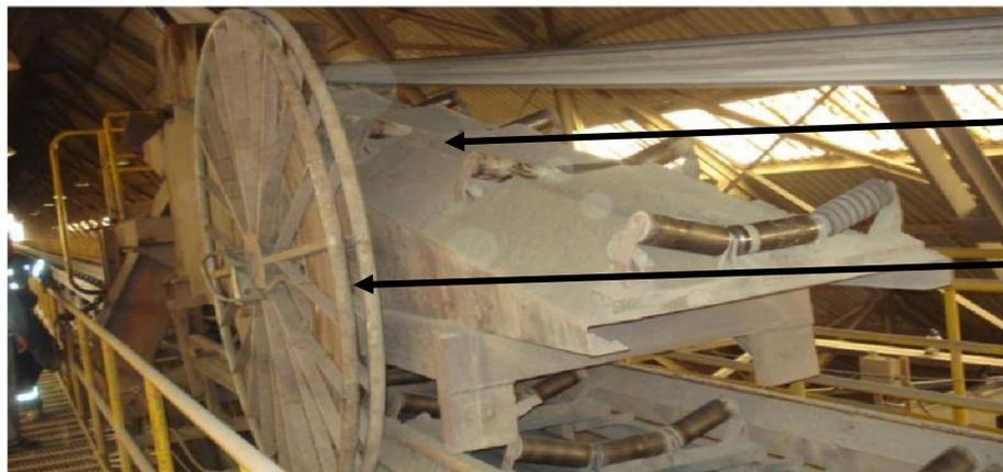
**Figure 2.11** Le jeteur et tendeur câble.
