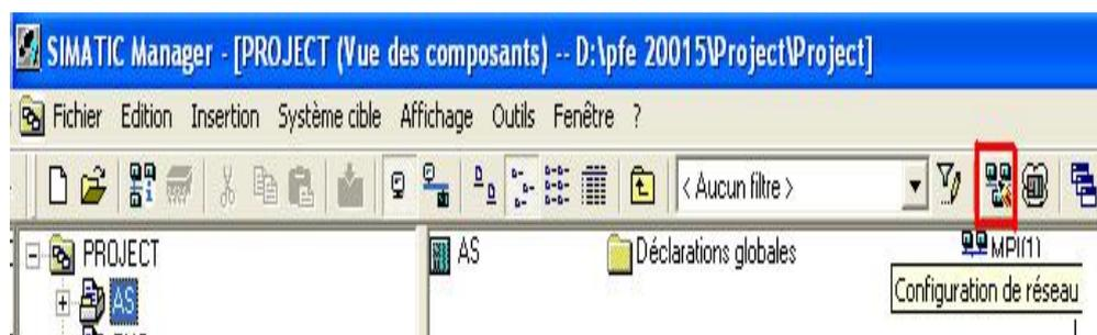
Figure 3.17 L'icône de configuration réseau.
