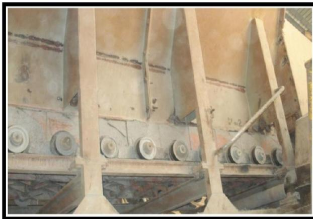
**Figure 2.4 :** Alimentateur à tablier métallique.
