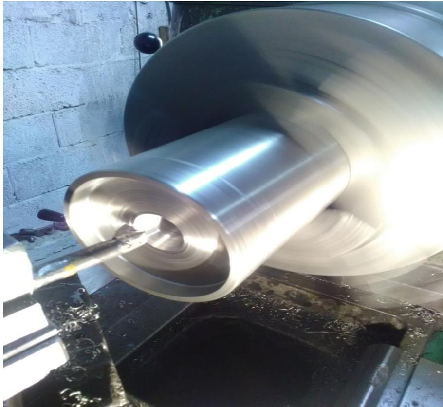
**Figure.III.4.** Usinage de la partie intérieure de la tuyère.
