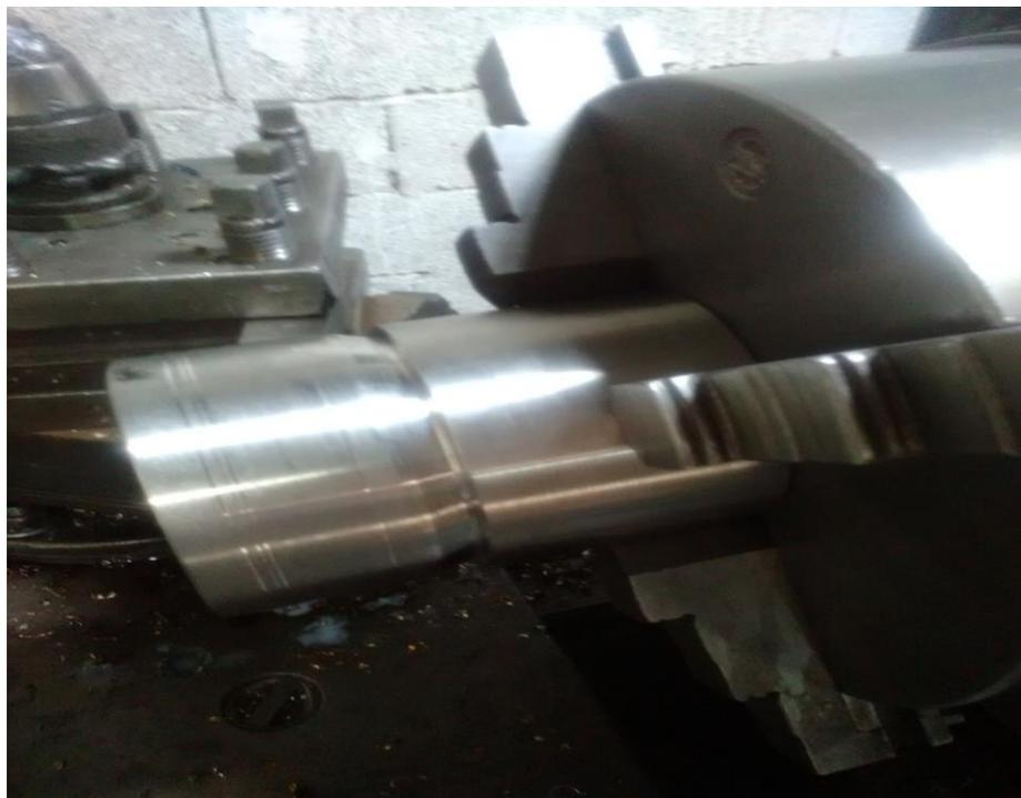
**Figure.III.5.** Usinage de la partie extérieure de la tuyère.
