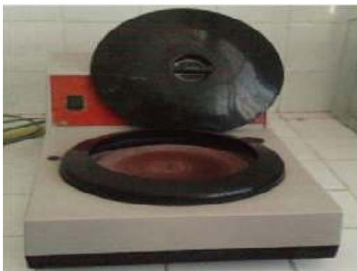
**Figure 4.6 :** Polisseuse de finition.
