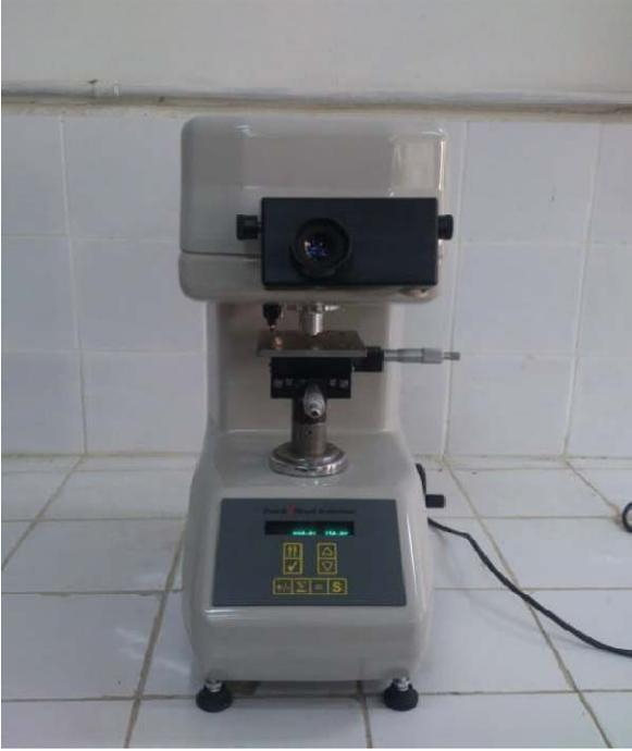
**Figure 4.7 :** Micro-duromètres.
