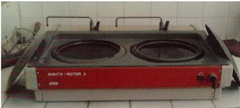
**Figure 4.5:** Polisseuse électrique à deux disques
