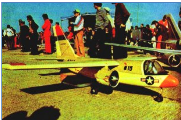
Figure (I-5): Une maquette équipée de deux turbines du Lockheed S3-A «Viking».
