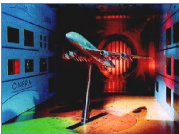
Figure (I-6): Maquette d'A380 dans la soufflerie F1 du Centre Onera du Fauga-Mauzac.
