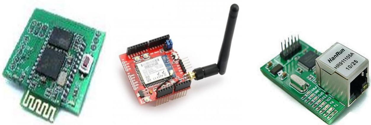
*Figure 2.5. Les cartes d'interfaces : Bluetooth, Wifi et Ethernet*
