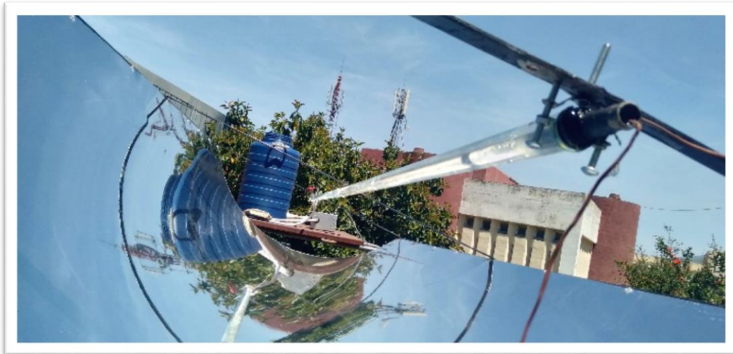
Figure 3.30 Image des thermocouples pour la température de sortie et de vapeur
