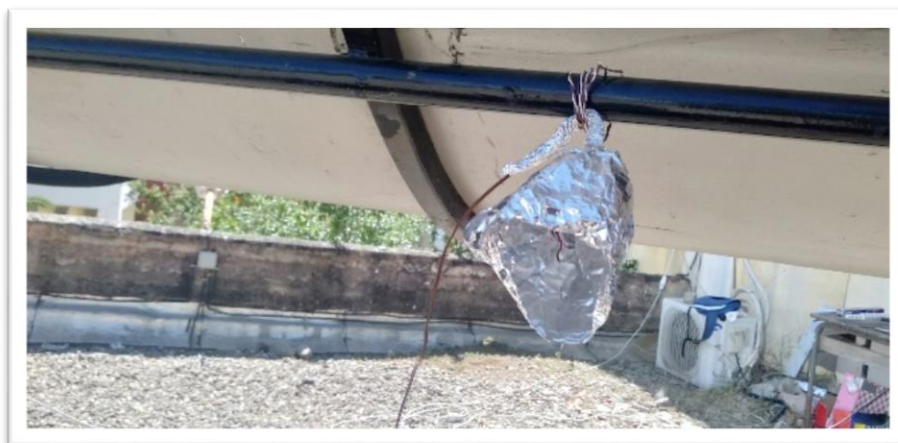
Figure 3.29 thermocouple pour la mesure de la température ambiante
