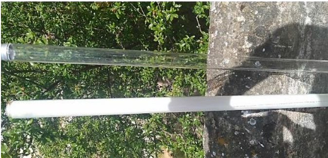
Figure 3.24 image de comparaison entre le tube de néon avant et après nettoyage
