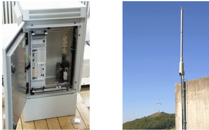
Fig. III.9 : Station sol et antenne ADS-B basée sur le Squitter étendu 1090 MHz. [29]
